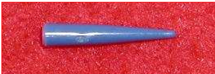
Figura 6: Punta de teflón para ultrasonido.
