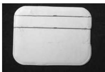
Fig. 5: Película radiográfica marcada para la colocación de la lámina de cobre.
