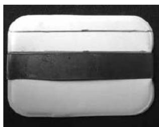
Fig. 6: Radiografías colocadas en el negoscopio para realizar las lecturas.
