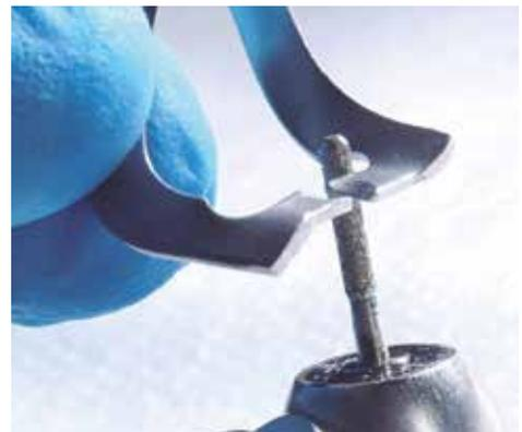
Figura 6. Modificación realizada con piedra de diamante cilíndrica.
