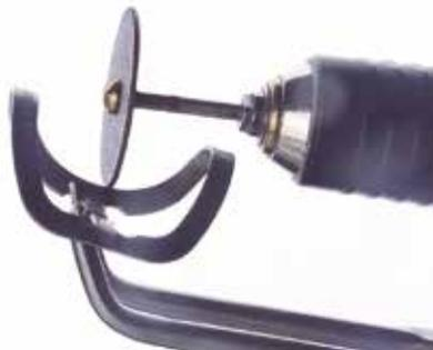
Figura 5. Procedimiento de corte de un arco del clamp #212 con un disco de carborundum.
